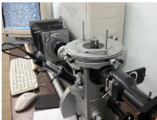
Рис.1. Загальний вигляд металографічного USB – мікроскопу на базі приладу MIM - 8
